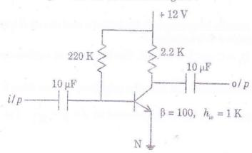
(i)  $I_{CQ}$  ; (ii)  $V_{CEQ}$  ; (iii)  $V_{BN}$  ; (iv)  $V_{CN}$  ; (v) Draw the d.c. load line.
